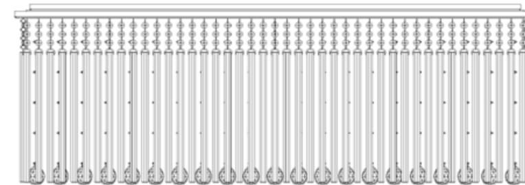
**Acabament** Material da base - alumínio pintado a pó em poliéster; Espelho em alumínio polido italiano; Cabo de aço inox 304; Prensa cabo em latão niquelado.
