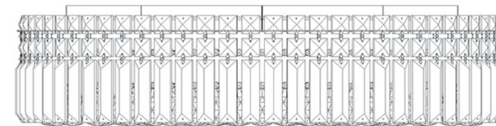
**Acabamento** Material da base - alumínio pintado a pó em poliéster; Espelho em inox 304; Cabo de aço inox 304; Prensa cabo em latão niquelado
